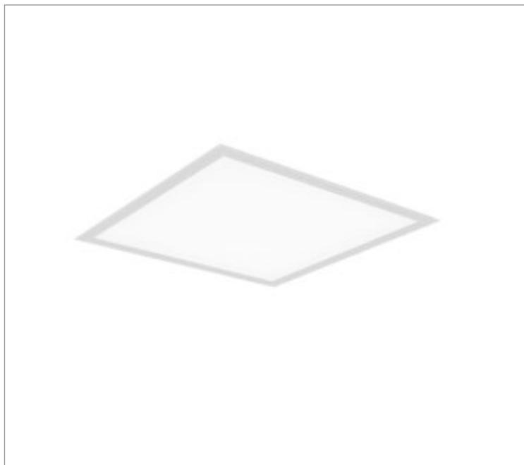
Luminária quadrada de embutir em forro de gesso, 26W 4000K IRC>80. Corpo em polímero injetado. Acabamento Branca. Controle óptico principal através de fecho difuso. Luminária grau de proteção IP-20. Driver corrente constante Liga/Desliga, Triac, 1-10V ou Dali (consultar condições). Tensão de trabalho 220V ou Bivolt.
